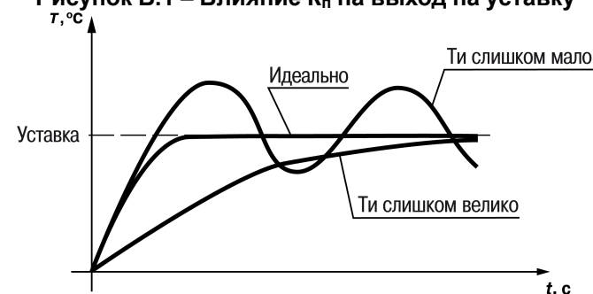
Рисунок Б.2 – Влияние T_i на выход на уставку
