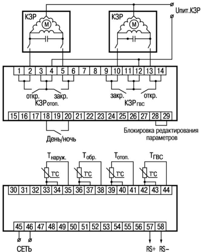
Рисунок В.2 – Схема подключения ТРМ32-Щ4
