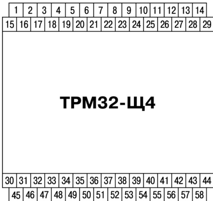
Рисунок В.1 – Схема расположения клеммных соединителей TRM32-Щ4
