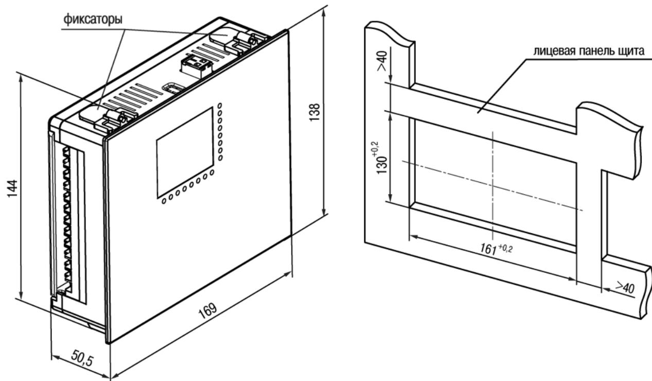
**Рисунок Б.2 – Габаритные и установочные размеры ТРМ32-Щ7**
