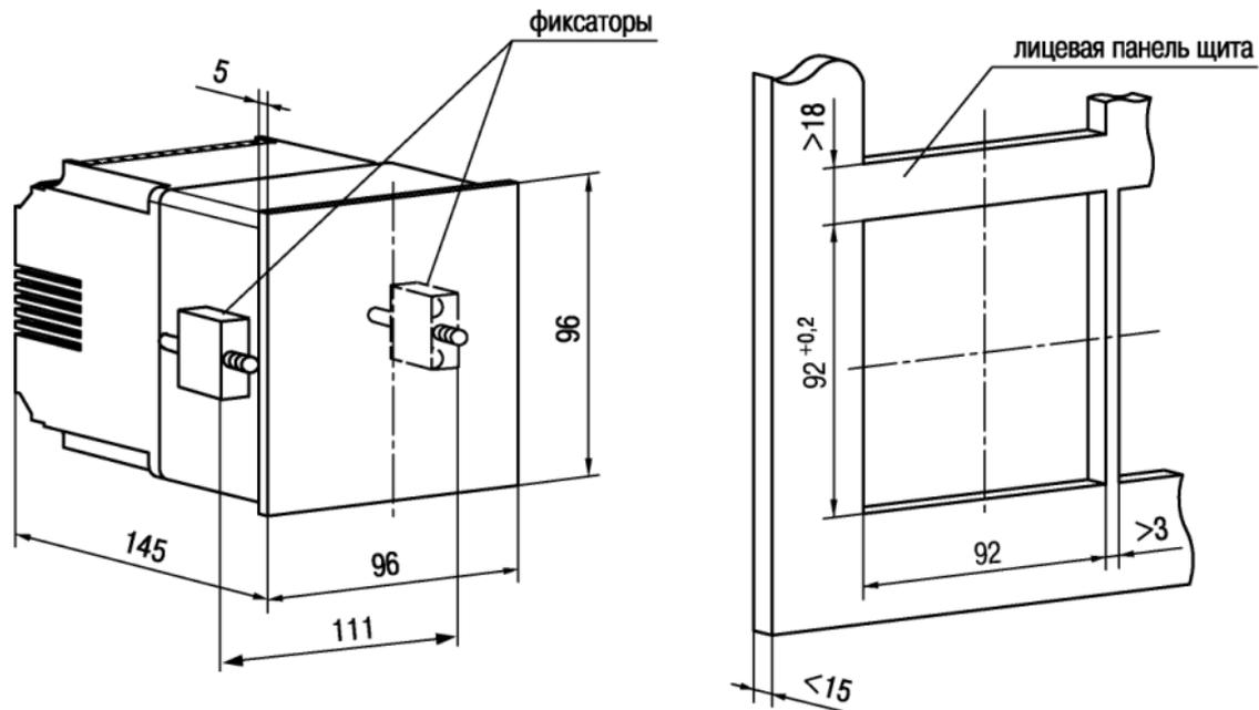
Рисунок Б.1 – Габаритные и установочные размеры ТРМ32-Щ4
