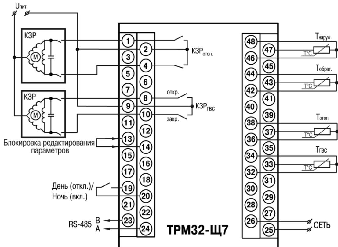
Рисунок В.3 – Схема подключения TRM32-Щ7
