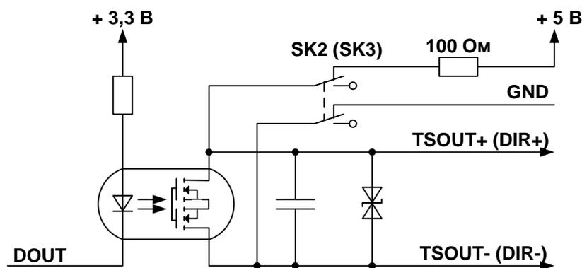
Рис.Б.1. Схема оконечного каскада универсальных выходов блока измерения.
