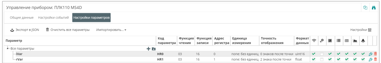
Рисунок 5.13.7 – Настройка параметров Modbus
