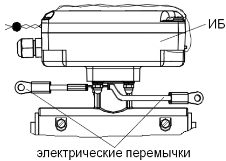
Рис.10. Электрические перемычки на ИБ расходомера.
